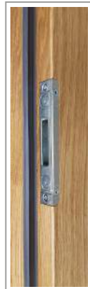
3 - TOČKOVNA VARNOSTNA KLJUČAVNICA dva močna (konična) kavlja, posamezni zapirni elementi na podboju, srebrno cinkana, varnostni razred RC1
