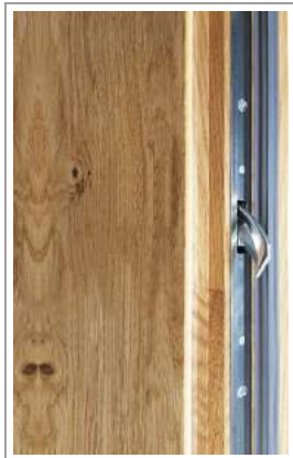
3 - TOČKOVNA VARNOSTNA KLJUČAVNICA dva močna (konična) kavlja, posamezni zapirni elementi na podboju, srebrno cinkana, varnostni razred RC1
