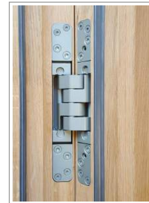
SKRITA NASADILA (standardno samo pri poravnani izvedbi vrat) 3D nastavljiva, nosilnost 160 kg, srebrna barve
