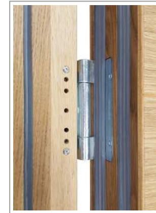
STANDARDNA NASADILA 3D nastavljiva, nosilnost 160 kg, premer 20 mm, srebrna barve
