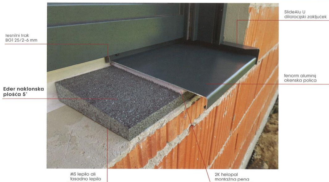
Slika 7: Montažna pena pod polico mora biti nanešena min pod 80% površine police, v debelini max 20 mm
